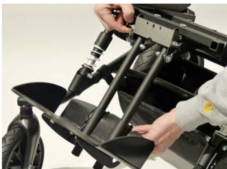
Si su cochecito de rehabilitación **Bingo Switch** está equipado con una plataforma de reposapiés de 90°, el reposapiés podría estar en una posición con bisagras para el transporte.
