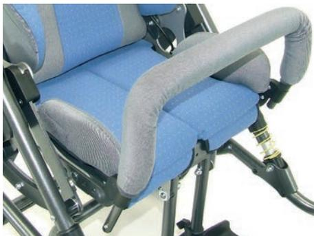
Para quitar la barra delantera, párese de lado mirando en la dirección de la unidad de asiento. Sujete la parte superior del soporte para accesorios de arriba a izquierda y derecha. Retire la barra delantera presionando los botones a presión y tire de la barra hacia arriba.
