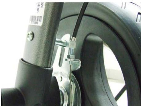
Después de aflojar la contratuerca, la tensión inicial se puede ajustar atornillando la guía del cable Bowden.
