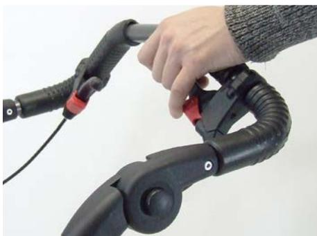
Cada freno de tambor se acciona mediante una palanca de freno. Para aplicar el freno de tambor, apriete la palanca de freno.
