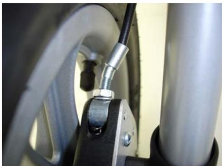
A la salida de cada caja de freno, el tornillo de fijación con manivela que conduce el cable del freno del neumático a la llanta de la rueda trasera. Después de aflojar la contratuerca, se puede ajustar la pretensión del freno individual (izquierdo o derecho).
