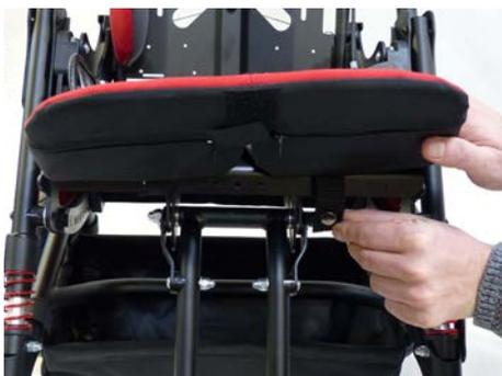
Recomendamos ajustar la unidad del asiento en la posición deseada antes de colocar la tapicería. (Inclinación del respaldo e inclinación del asiento - véase el apartado 5).
