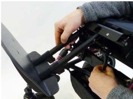
Si su **Bingo Switch** está equipado con una plataforma de reposapiés ajustable en ángulo, el reposapiés podría estar en una posición con bisagras para el transporte.
