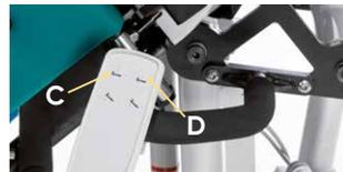
**En el caso de que los motores no se retraigan y extiendan como se desea, los motores deben retraerse completamente para volver a determinar la posición en el software. Para ello, pulse los dos botones C + D del mando manual hasta que los dos motores estén completamente retraídos. Si así no se solucionase el problema, contacte con su distribuidor especializado (véase el punto 8.5).**
