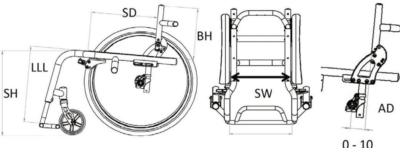
**SH**=Altura asiento / **LLL**= Altura reposapiés / **SD**=Profundidad asiento / **BH**= Altura respaldo / **SW**= Ancho asiento / **AD**=Grado activo
