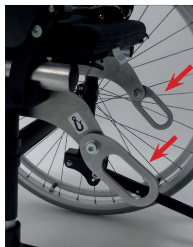
Puntos de fijación, traseros según ISO 7176-19
