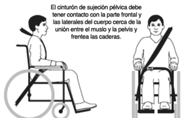
Figura 3b - Ubicación y posicionamiento correcto del cinturón de sujeción en el ocupante de la silla de ruedas
