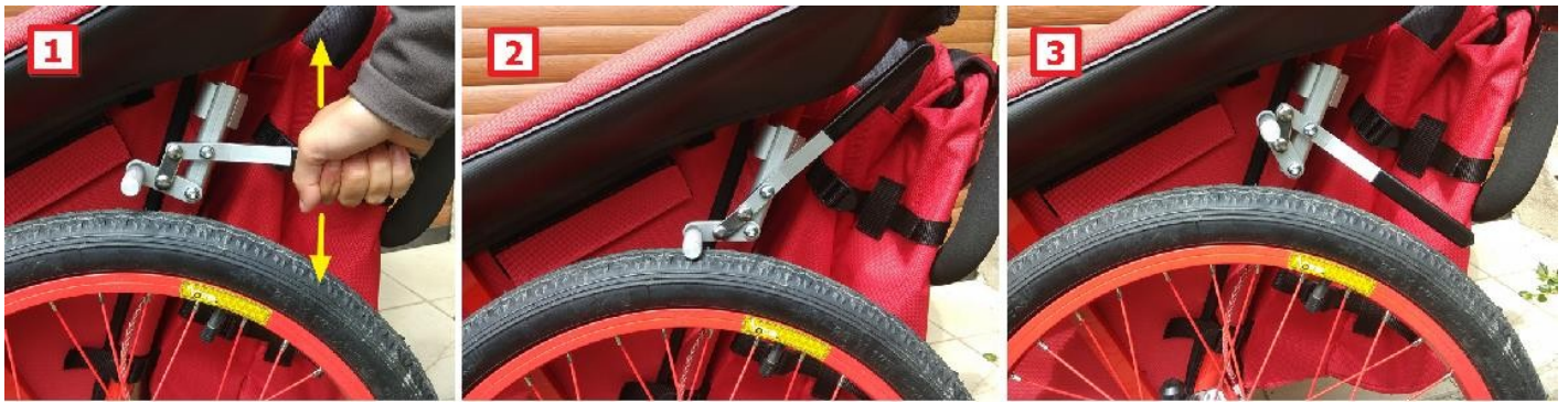
Figura 28 1- agarre adicional del freno de estacio. 2 - el freno está completamente enganchado 3 - el freno está liberado
