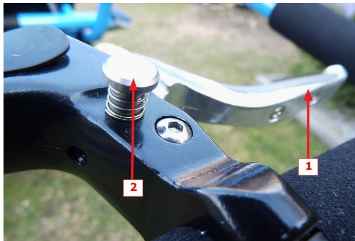
B - freno de estacionamiento activado
