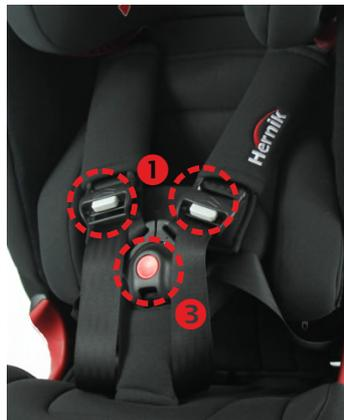
Si desea sacar al niño del asiento del automóvil, primero afloje el cinturón presionando el botón gris en el ajustador del cinturón ❶ y tirando de las correas. Luego, la hebilla del cinturón ❸ se puede abrir presionando firmemente el botón rojo redondo.
