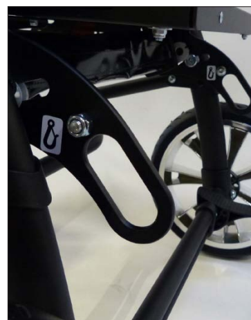
Puntos de sujeción, traseros según ISO 7176-19.
