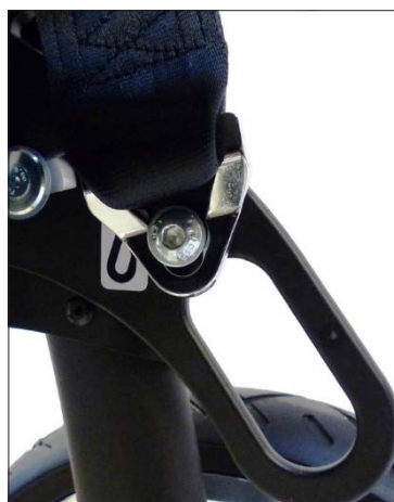
Puntos de sujeción, traseros según ISO 7176-19 para cinturón pélvico
