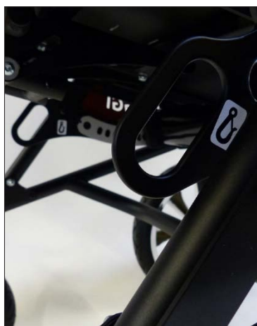
Puntos de sujeción frontal según ISO 7176-19
