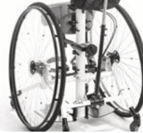
Protector de radios transparente
