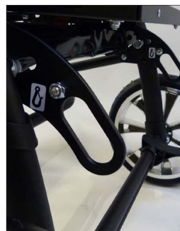
Puntos de fijación, detrás según ISO 7176-19
