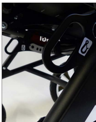
Puntos de fijación, frente según ISO 7176-19
