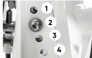
Recuerde que al reajustar la inclinación de la rueda también se cambia la posición de las ruedas de apoyo y debe adaptarlas en altura (véase el punto 3.5).
