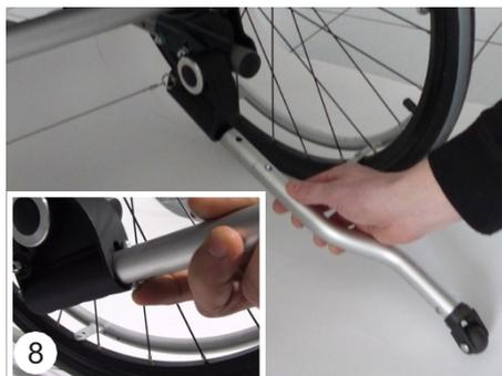
SWINGBO-VTi está equipado con dos dispositivos antivuelco. La imagen (9) muestra la posición "activa".
