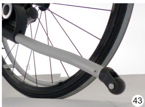
La imagen 43 muestra la posición del dispositivo antivuelco. El antivuelco debe ajustarse para que esté a 2-3 cm del suelo.
