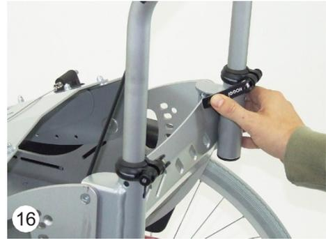
Cuando la palanca de leva está abierta, su tensión puede modificarse ajustando la tuerca (17).
