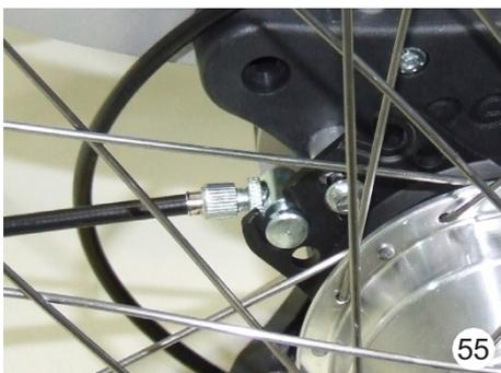
La fuerza de frenado se puede ajustar con el tornillo de ajuste (55).
