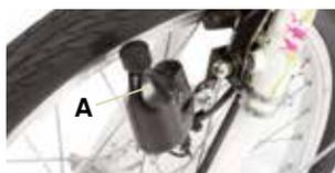
**Dinamo de buje:** El dinamo de buje está integrado en la rueda y se enciende con el interruptor **(B)** en el faro.
