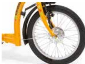
**El efecto de frenado se puede perder si se utiliza con mucha frecuencia, por eso debe prestar atención a que el cable Bowden del freno se reajuste con regularidad, cuando perciba que pierde fuerza de frenado (véase el punto 3.2.1)**
