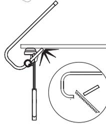
NOTA: El brazo medio se puede cortar hasta la longitud deseada con ayuda de una sierra para metales o un corta tubo.
