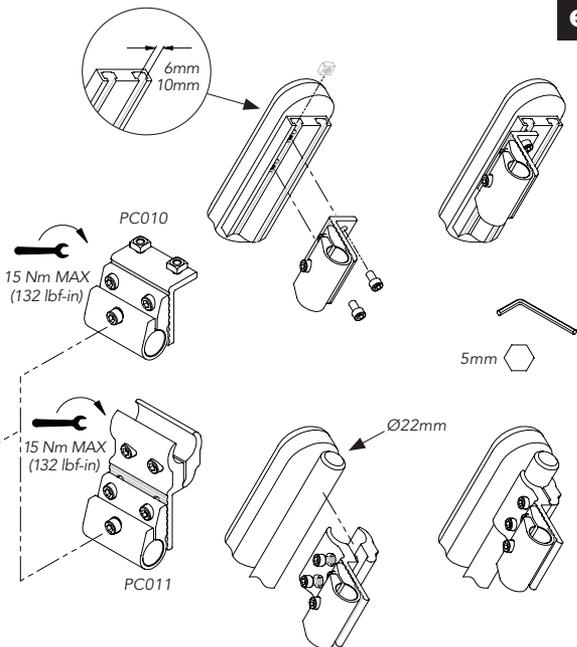
La abrazadera de montaje del joystick se puede instalar en el reposabrazos lateral derecho o izquierdo. Acople la abrazadera al reposabrazos. Coloque la abrazadera lo más adelante posible y apriétela.
