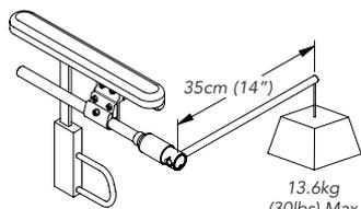
El Eje giratorio Tri-Lock es compatible con el lado derecho o izquierdo de montaje. Gire el eje de la abrazadera de montaje para asegurar la correcta posición de rotación.
