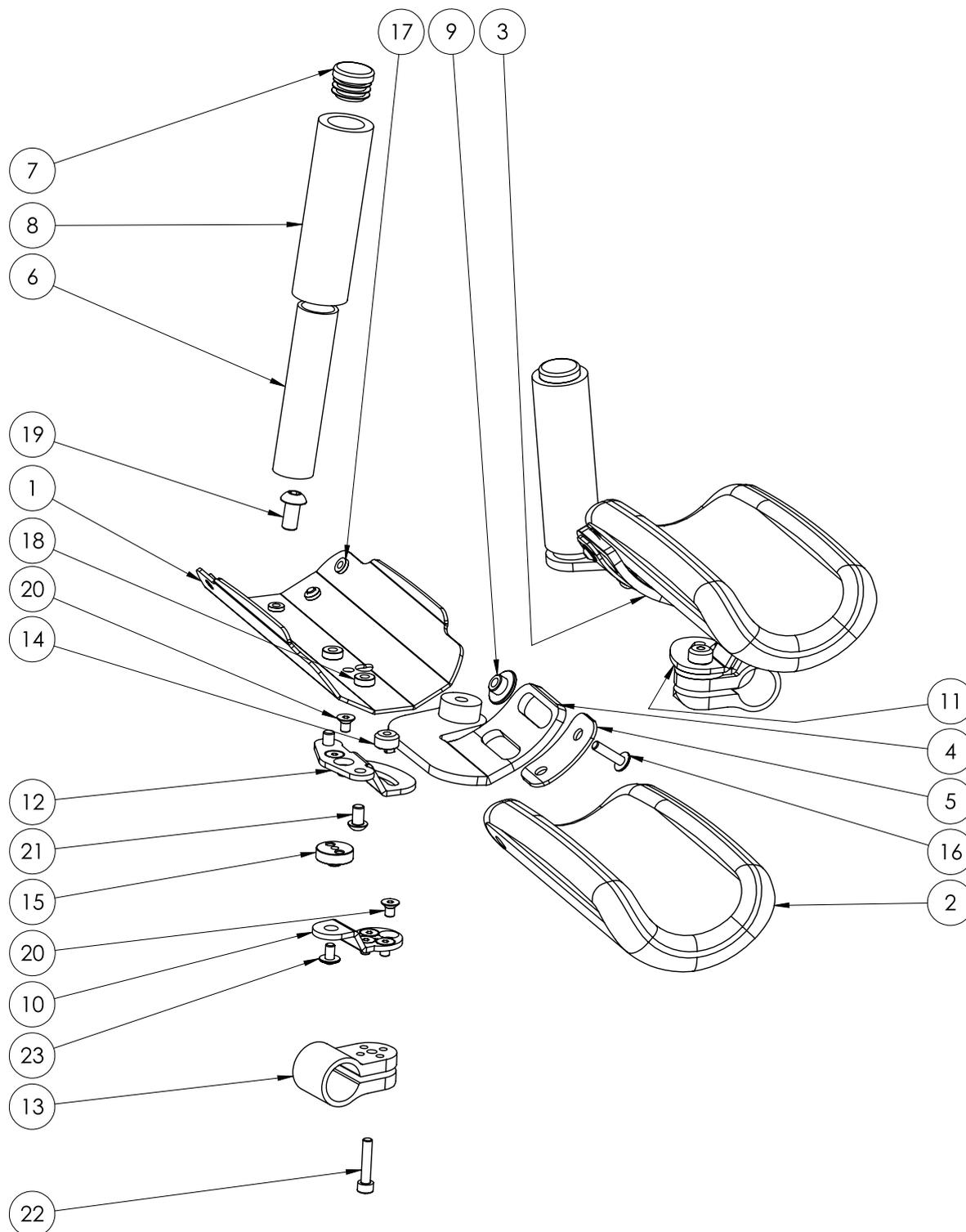
**Ersatzteilliste - Unterarmauflage mit Handgriffen Gr. 1 + 2 / bis Baujahr 05-2022**
