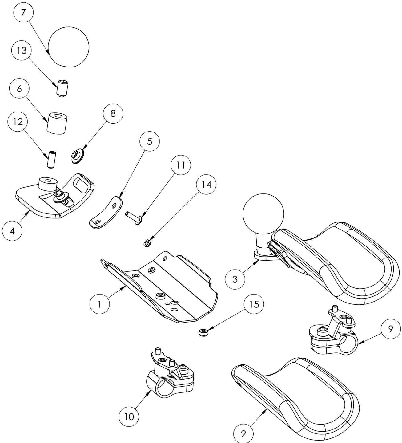
**Ersatzteilliste - Unterarmauflage mit Griffkugeln Gr. 1 + 2 / ab Baujahr 05-2022**
