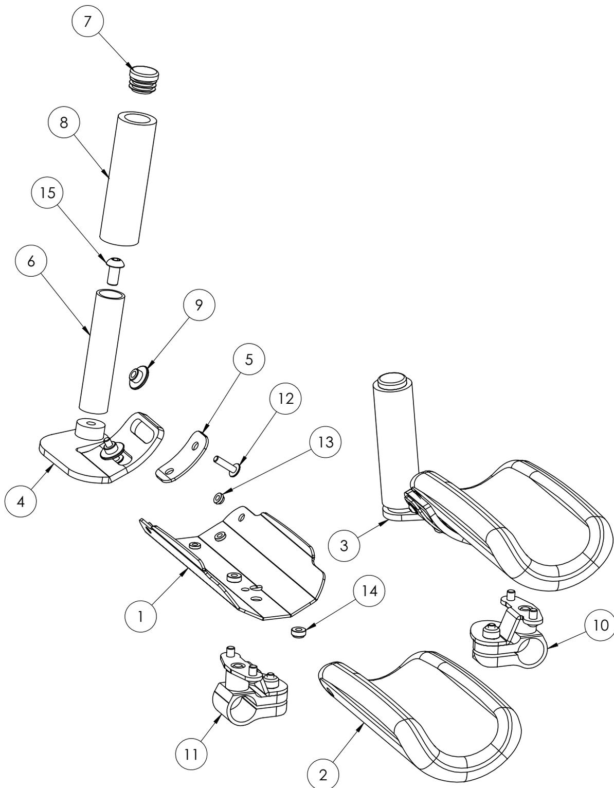
**Ersatzteilliste - Unterarmauflage mit Handgriffen Gr. 1 + 2 / ab Baujahr 05-2022**
