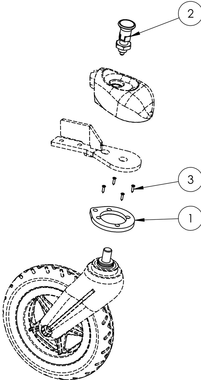
**Ersatzteilliste - Richtungsfeststeller für Gr. 0-3**
