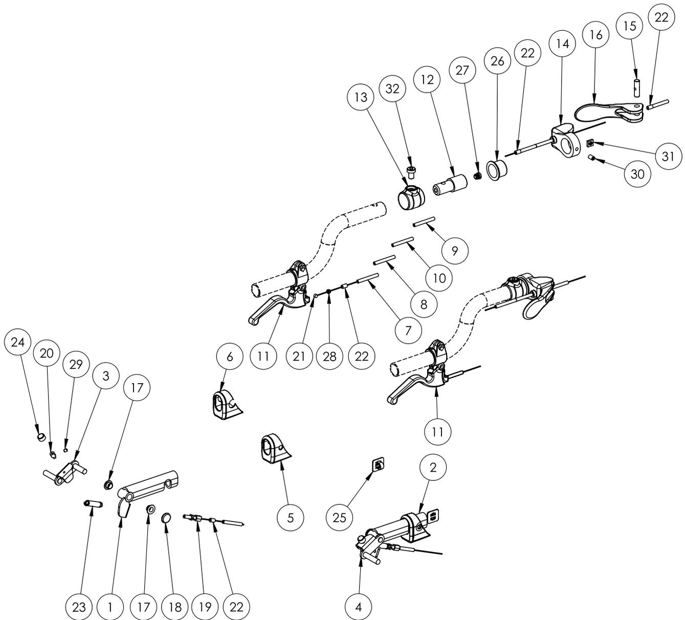
**Ersatzteilliste - Handbremse klein Gr. 0-3**
