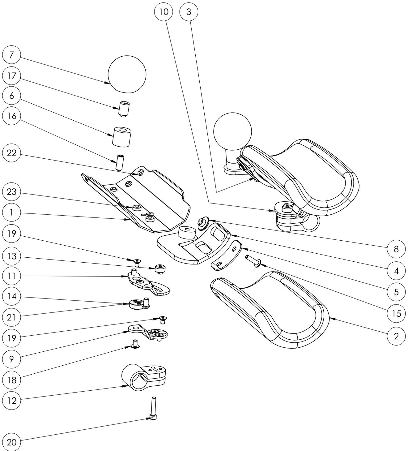
**Ersatzteilliste - Unterarmauflage mit Griffkugeln Gr. 1 + 2 / bis Baujahr 05-2022**
