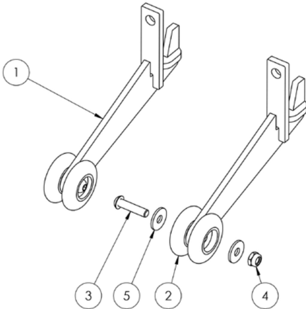
**Ersatzteilliste - Kippsicherung für malte. Gr. 2 - 4**
