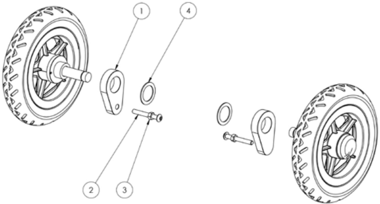
**Ersatzteilliste - Schleifbremse für malte. Gr. 0 + 1**
