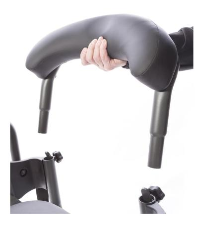
La parte superior del respaldo está a 38 cm del asiento. El respaldo se desmonta con dos perillas y permite el acceso trasero para transferencias de usuarios.
