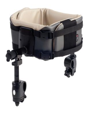
El soporte de pecho está disponible en dos tamaños y se adapta a una amplia gama de usuarios. Con el soporte podemos controlar el ángulo deseado del tronco del paciente, es ajustable en inclinación hacia delante o hacia atrás en incrementos de 15 °. Una perilla ajusta tanto el ángulo de inclinación y la anchura de la línea de pecho.
