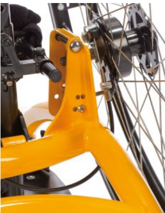
Ajust inclinació de les rodes Todd
