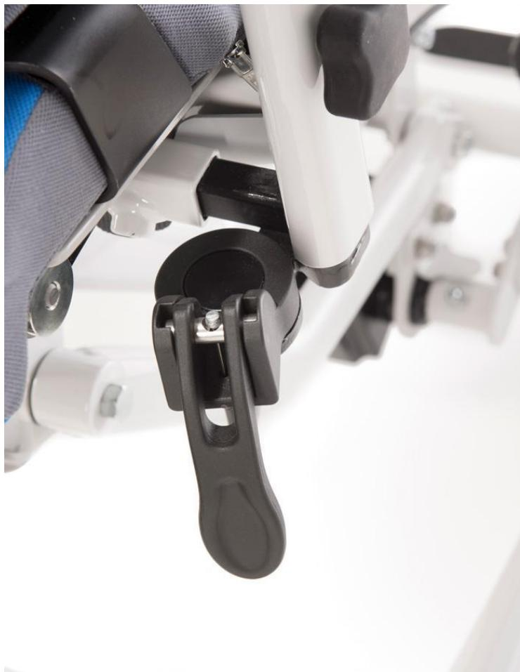
El freno de estacionamiento central lleva incluidas 4 ruedas de 100 mm y se acciona usando una palanca de freno montada en el sistema de asiento.
