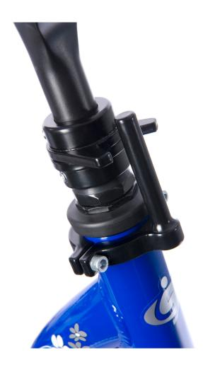
el limitador de dirección es ajustable hasta bloquear la dirección
