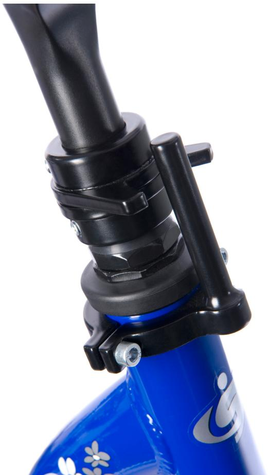
el limitador de dirección es ajustable hasta bloquear la dirección
