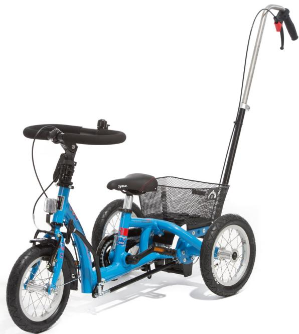
La barra de empuje es ajustable y extraíble con bloqueo giratorio integrado.
