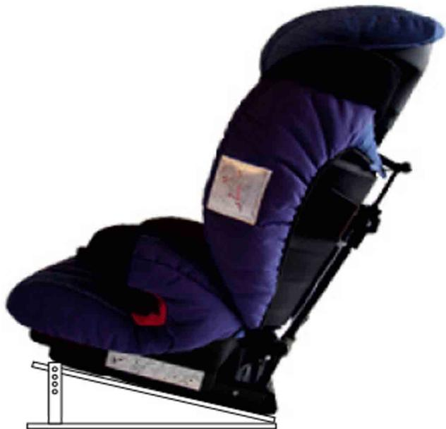
La base ajustable en inclinación nos permite ajustar de 0º-10º.
