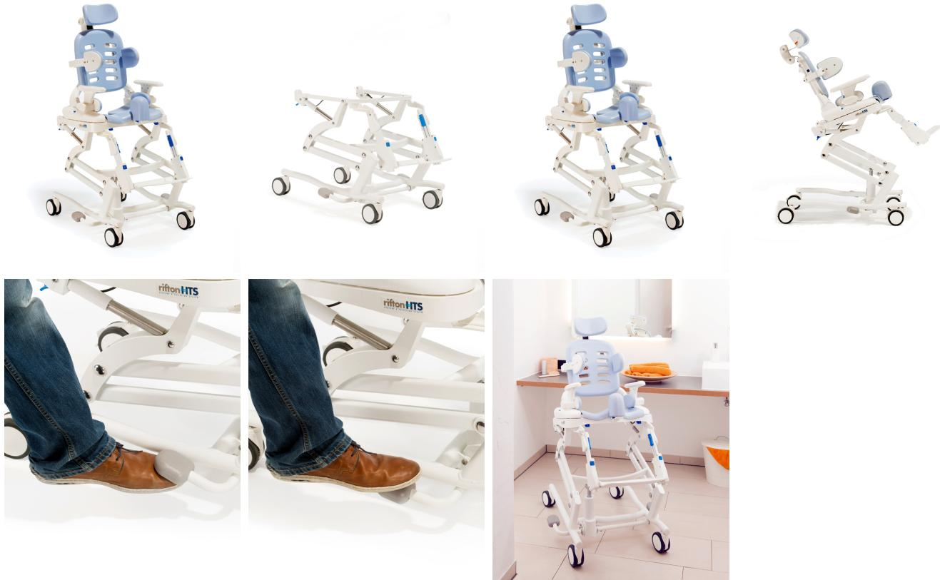
La Base Hi-Lo del **sistema d'hygiene HTS** és la millor opció per a aquelles persones que necessiten regular l'altura del seient mentre l'usuari és a sobre. L'alçada s'ajusta fàcilment i sense esforç mitjançant un pedal situat a banda i banda de la Base. Fabricada en acer inoxidable, amb reposapeus, rodes dobles de 100 mm regulables en alçada, basculant i disponible en les tres talles de l'HTS.
