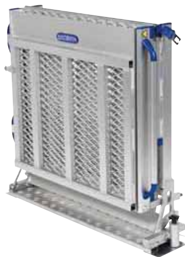
OPCIÓN: RAMPA MONTADA SOBRE BASE GIRATORIA
