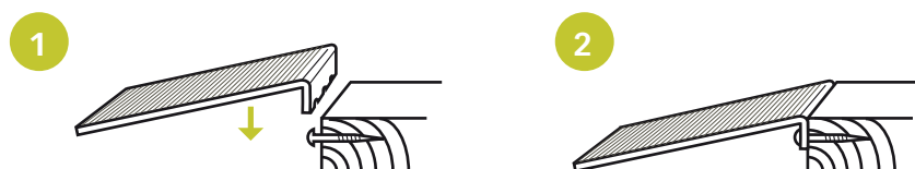
MONTAJE TÍPICO EN ENTRADA DE UNA VIVIENDA
